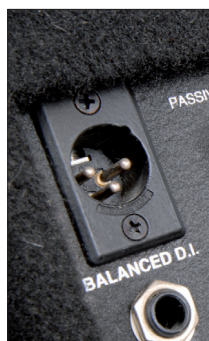
Balanced DI output
